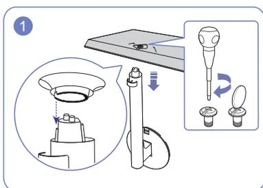
Inserte el conector del soporte en éste en la dirección que se muestra en la ilustración. Gire completamente el tornillo de conexión en la parte inferior del soporte para que quede firmemente sujeto.
