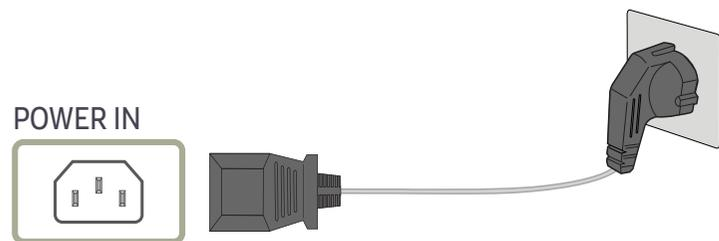
Para utilizar el producto, conecte el cable de alimentación a una toma de corriente y al puerto **POWER IN** del producto.
