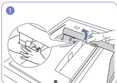
Coloque el producto sobre una superficie limpia y plana, tal como se muestra en la ilustración. Empuje la pestaña hacia arriba y manténgala presionada. Gire 10° el cuello del soporte de la pantalla en el sentido contrario a las agujas del reloj.
