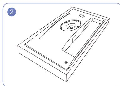
Coloque en el suelo el acolchado protector de poliestireno extrusionado (Styrofoam) incluido en el paquete y, a continuación, coloque el producto boca abajo sobre el protector, como se muestra en la imagen.
