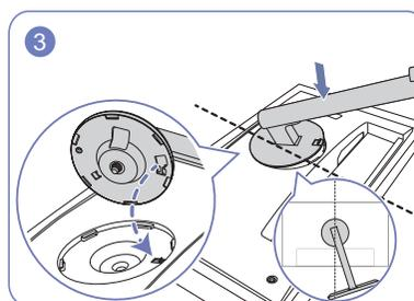
Coloque el cuello del soporte sobre la pantalla, tal como se muestra en la ilustración. Asegúrese al colocar el cuello del soporte de que el botón en relieve de la pantalla puede insertarse en la muesca que hay en el cuello del soporte.
