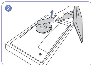
Levante el cuello del soporte en la dirección indicada por la flecha, para separarlo de la pantalla.
