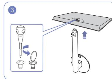
Afloje el tornillo de conexión ubicado en la parte inferior de la base del soporte y, a continuación, separe el cuello del soporte y la base, tirando del cuello en la dirección indicada por la flecha, tal como se muestra en la ilustración.
