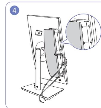
Pase los cables a través de la muesca de la CUBIERTA POSTERIOR y luego encaje la SUBCUBIERTA POSTERIOR. Cuando encaje la SUBCUBIERTA POSTERIOR, primero alinee las seis puntas de la SUBCUBIERTA POSTERIOR con los agujeros de la CUBIERTA POSTERIOR.
